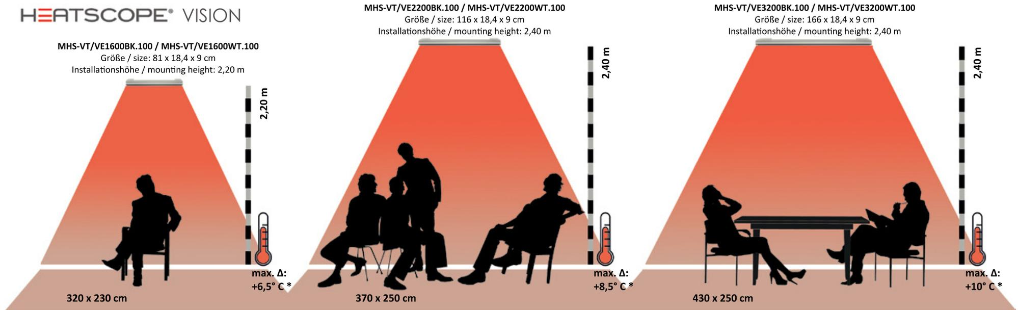
\* Max. Temperatur-Steigerungen nach 35 Minuten im geschlossenen Raum bei 16,0° C ohne Windeinfluss etc. erreichbar. 85-90% der Leistung wird nach max. 7–10 Minuten erreicht, 100% nach max. 35 Minuten. Alle Angaben sind Circa-Werte. Empfohlene Installationshöhe: 1,80 bis max. 2,50 m (abhängig von der jeweiligen Installationsumgebung).
