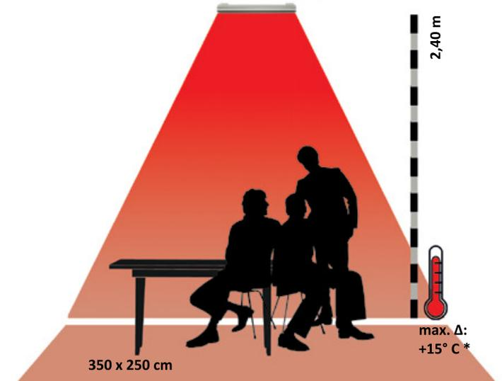
\* Max. Temperatur-Steigerungen nach 35 Minuten im geschlossenen Raum bei 16,0° C ohne Windeinfluss etc. erreichbar. 85-90% der Leistung wird nach max. 5–8 Minuten erreicht, 100% nach max. 35 Minuten. Alle Angaben sind Circa-Werte. Empfohlene Installationshöhe: 1,80 bis max. 3,00 m (abhängig von der jeweiligen Installationsumgebung).
