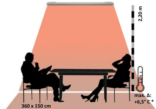
\* Max. Temperatur-Steigerungen nach 35 Minuten im geschlossenen Raum bei 16,0° C ohne Windeinfluss etc. erreichbar. 85-90% der Leistung wird nach max. 15 Minuten erreicht, 100% nach max. 35 Minuten. Alle Angaben sind Circa-Werte. Empfohlene Installationshöhe: 2,10 bis max. 2,30 m (abhängig von der jeweiligen Installationsumgebung).
